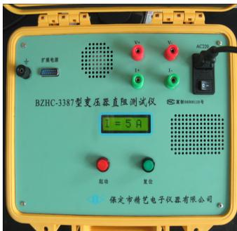
BZHC-3387 型变压器直流电阻测试仪是新一代便携式变压器直流电阻测试仪；该仪器将高稳定电源和测试部分设计成一体，测试全过程由单片机控制完成，仪器操作简单，测试数据稳定准确，不受人为因素影响；仪器采用带背光的点阵字符液晶显示，适宜不同的测试环境；具有完善的反电势保护功能和现场抗干扰能力。可与外置恒流源连接、灵活方便，适用与从配电变压器到大型电力变压器的直流电阻快速测试。
